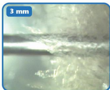
بزرگنمایی بلورهای واکس در سیستم هیدروکربن های سبک تحت فشار (Rocking Cell)
